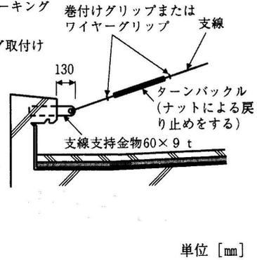
図3 支線取付側面図
