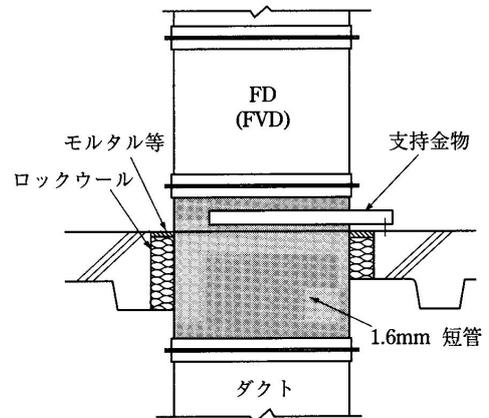
注) 実管打込み場合短管は内フランジ
